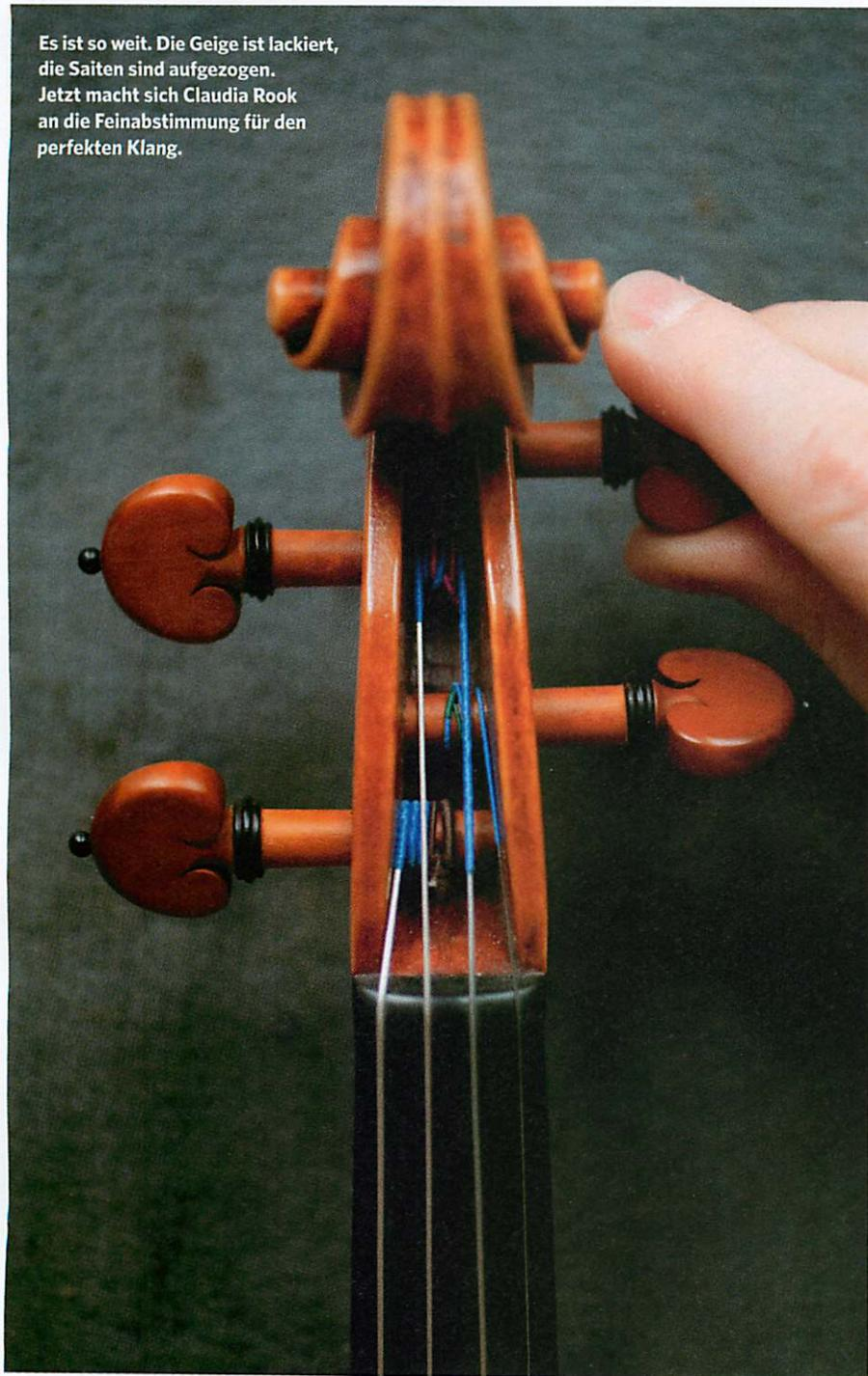
Der Lack wird nach alter Rezeptur aus dem 17. Jahrhundert angerührt, die Pinselstriche verleihen der Geige den typischen bernsteinfarbenen Glanz. Er dient aber nicht nur Optik und Schutz, er sorgt auch für guten Klang. Schließlich werden die Wirbel eingesetzt, der Stimmstock, die Seele des Instruments, eingepasst, das Griffbrett angebracht, die Saiten aufgezogen. Dann endlich kann die Violine gestimmt werden.
