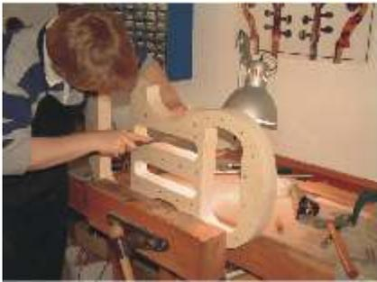
Abbildung 5 (unten): Die Herstellung der Innenform ist die Grundlage für die weitere Arbeit am Violoncello
