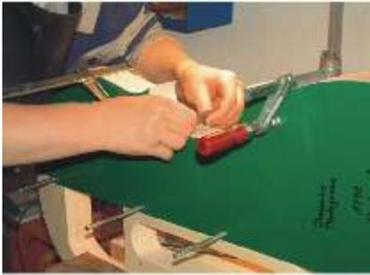
Abbildung 4 (oben): Die Spitzschablone wird auf die Innenform übertragen
